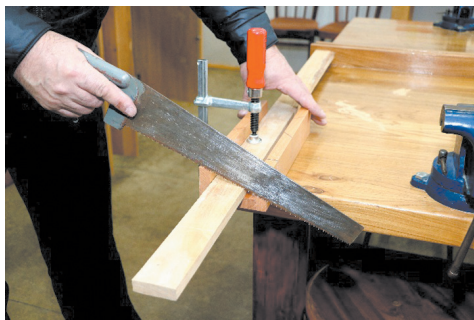
68-сүрөт. 1 - катуу басып араалоо; 2 - стуслонун ичинде араалоо
