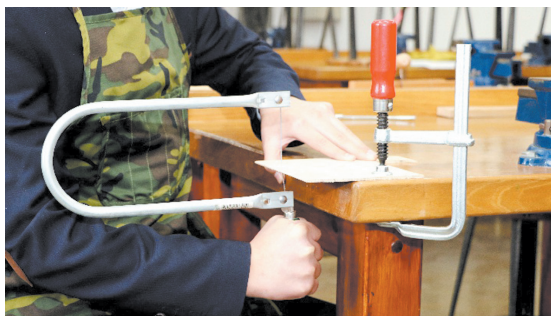
72-сүрөт. 1 - лобзик менен араалоо; 2 - струбцина
