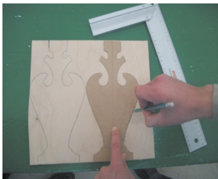
67-сүрөт. Шаблондун (шарттуу өлчөгүч) жардамы менен белгилөөлөрдү жүргүзүү
