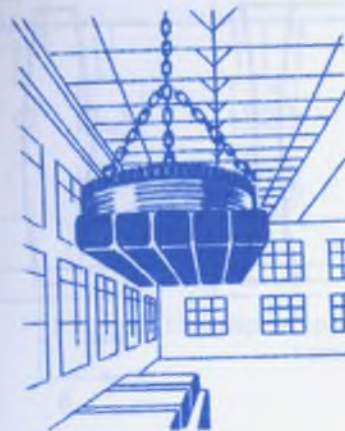
27-сүрөт. Оор жүк көтөрүүчү электр-магниттик кран.
