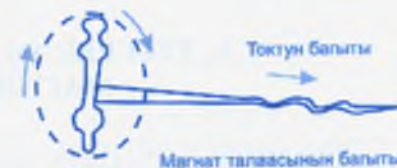
17-сүрөт. Түз токтун магнит талаасын бурама эрежеси боюнча аныктоо.
