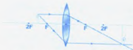
116-сүрөт. Нерсе линзанын фокусу менен кош фокусунун арасында жайгашкан.
