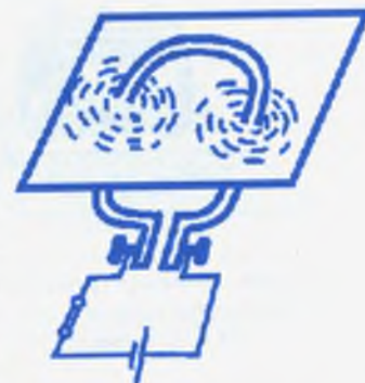
21-сүрөт. Тегерек токтун магнит талаасын үйрөнүүчү түзүлүш.
