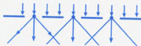
142-сүрөт. Дифракциялык торчонун жылчыктарынан өткөн нурдун багытынын өзгөрүшү менен өзара катталышы.
