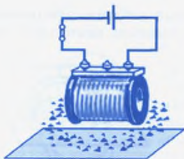
24-сүрөт. Чынжыр туюкталганда темир таарынды катушканын учтарына тартылышат.
