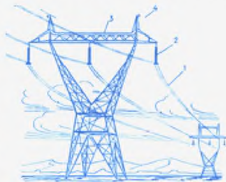
42-сүрөт. Электр берүүчү тармактын бөлүктөрү.
