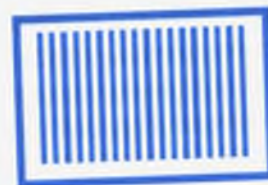
139-сүрөт. Дифракциялык торчо. Дифракциялык торчонун мезгили.
