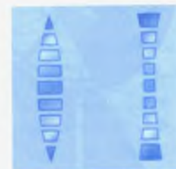
103-сүрөт. Линза үч бурчтуу призмалардын жыйындысы.
