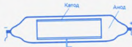
160-сүрөт. Гейгер–Мюллер эсептегичинин схемалык көрүнүшү.
