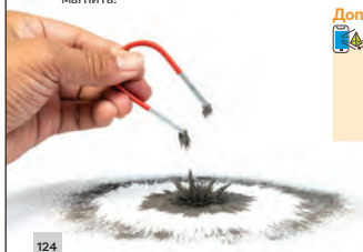
железные опилки, притягиваемые к стержневому магниту
