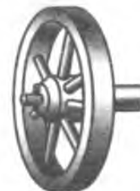
208-сүр. Арабанын дөнгөлөгү менен жан жыгачынын огунун эң жөнөкөй биригүүсү
