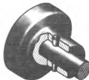
228-сүр. Штифт менен бириктирүүнүн айкын сүрөттөлүшү
